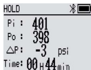
Imagen 6 - Interfaz de la prueba de estanqueidad
